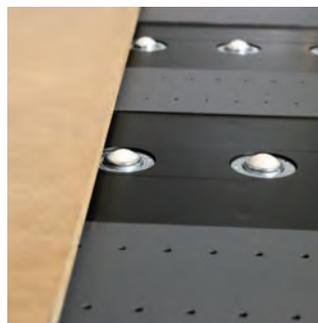
I **nastri a depressione ABF** di Jeti Tauro sono sempre perfettamente allineati e caricano agevolmente il materiale nella macchina da stampa. Numerosi rulli di rilascio sul retro del piano di lavoro supportano questo processo di caricamento. Mentre un pannello viene stampato, i nastri a depressione sul lato anteriore vengono spenti per consentire il caricamento del pannello successivo.
