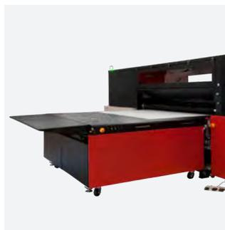
Il caricatore automatico (ABF) gestisce **fino a un massimo di 4 pannelli** affiancati, fino a una lunghezza massima di 1,85 m. È possibile il bypass per pannelli più lunghi (fino a un massimo di 4 m).
