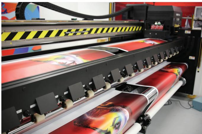
L'Oberon RTR3300 est disponible en version quatre couleurs plus blanc et en version six couleurs. La version quatre couleurs plus blanc se distingue par sa capacité à imprimer le blanc dans différents modes. Elle transforme ainsi le vinyle auto-adhésif, le film vinyle électrostatique ou le film rétroéclairé en des éléments graphiques dynamiques multicouches qui captent l'attention.
