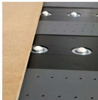
Les **courroies aspirantes** de l'ABF de la Jeti Tauro sont parfaitement alignées à tout moment, alimentant les supports en douceur dans le système d'impression. Plusieurs rouleaux de dégagement situés à l'arrière de la table prennent en charge ce processus d'alimentation. Lorsqu'un panneau est en cours d'impression, les courroies aspirantes situées à l'avant sont désactivées pour permettre le chargement du panneau suivant.
