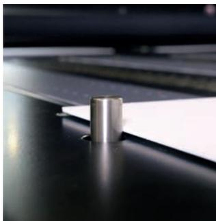
Les **taquets de repérage** garantissent (jusqu'à 1 mm) un alignement précis des panneaux, ce qui s'avère particulièrement pertinent pour les impressions recto verso. Le logiciel Asanti d'Agfa sélectionne automatiquement une configuration de réglage des taquets en fonction de la dimension des supports.
